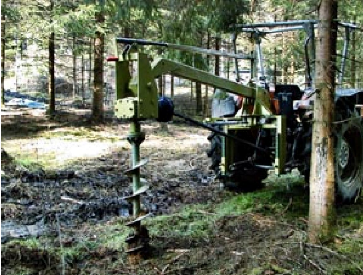
Abb.6: Pflanzlochbohrer im Einsatz ( http://www.somcon.com - abgerufen am 12.12.2007)
