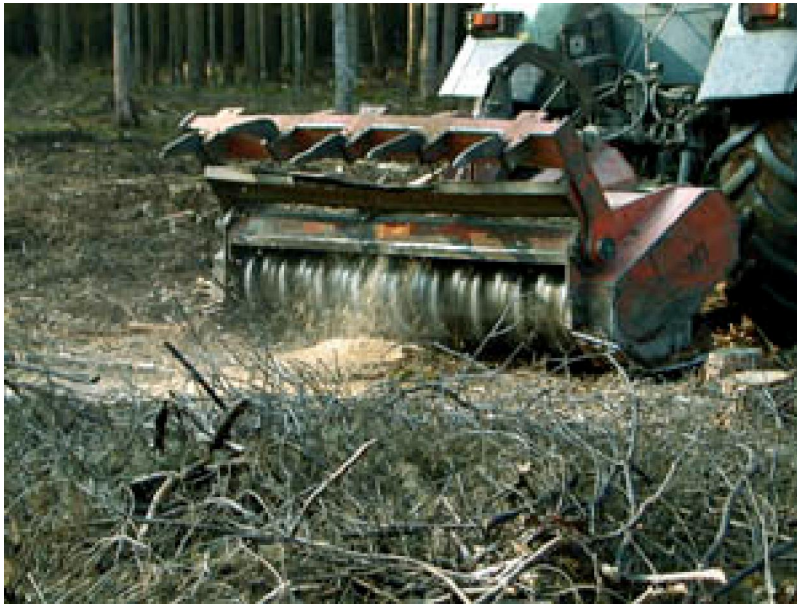
Abb.5: Stockfräse im Einsatz ( http://www.somcon.com - abgerufen am 12.12.2007)
