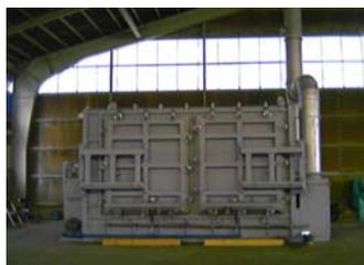
Fig. 3. 7 m<sup>3</sup> Carbonization apparatus.
